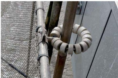
J'avoue qu'avec un coefficient de 90 et plus, le cadre aurait tendance à coincer en fin de montée. La raison est simple : les petits cylindres en téflon situés sur l'anneau arrivent parfois à se bloquer en frottant les uns contre les autres.
